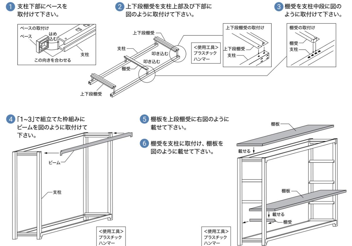
注意 棚受は、2ヶ所とも同じ高さに取り付け、爪が支柱にしっかり入っていることを確認して下さい。棚に載せているものが落下する原因になります。
