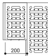
通気性、採光性に優れており、防災構造指定の床材に適しています。
