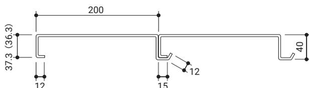
すぐれた断面形状で、隣り合う相互のフローアークに荷重が分散されるため、安心してご利用いただけます。
