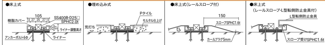
※L型転倒防止金具とスロープを同時に取付ける場合には、スロープ受けが別途必要です。
